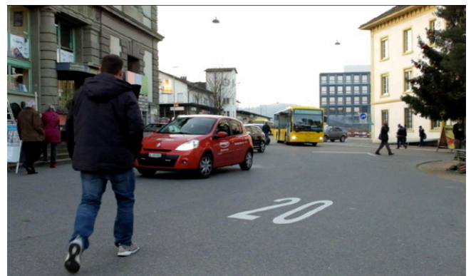
Abb. 11: Begegnungszone Bahnhof Liestal (BL) Bahnhofplätze mit kreuz und quer verlaufenden Fussgängerwunschl意思linien, regem Bus-, Taxi- und Bring-/Holverkehr sind prädestiniert für Begegnungszonen.
