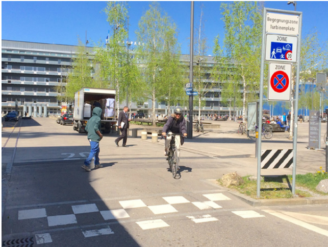
Abb. 12: Turbinenplatz im Entwicklungsgebiet Zürich West Neubauquartiere sind oft von sehr linearem Strassenverlauf geprägt, was dem Einhalten tiefer Geschwindigkeiten nicht gerade förderlich ist. Eine siedlungsorientierte Gestaltung mit verkehrsberuhigenden Massnahmen ist deshalb besonders wichtig.
